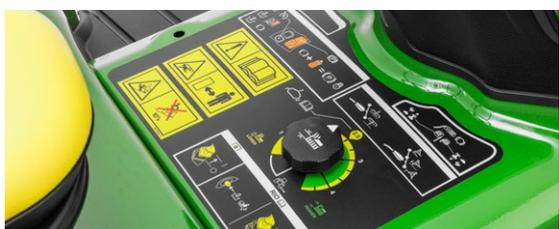
**Réglage aisé de la hauteur de coupe :** une molette sur la plateforme de conduite permet d'ajuster la hauteur de coupe par pas de 6 mm.
