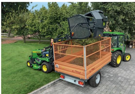
**Grande autonomie :** d'une capacité de 650 litres, le bac à bennage en hauteur permet de limiter les vidages, qui peuvent être effectués au milieu du conteneur ou de la benne, pour un remplissage efficace et régulier.
